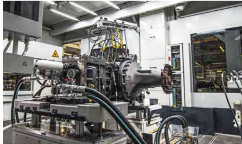
Es ist ein Test auf Herz und Nieren: ein Variogetriebe in der geschlossenen Prüfkabine. Nur 100-prozentige Qualität kommt hernach im Traktor zum Einbau.
